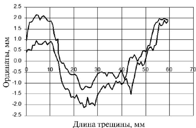
Рисунок 3. Компьютерная модель берегов трещины
