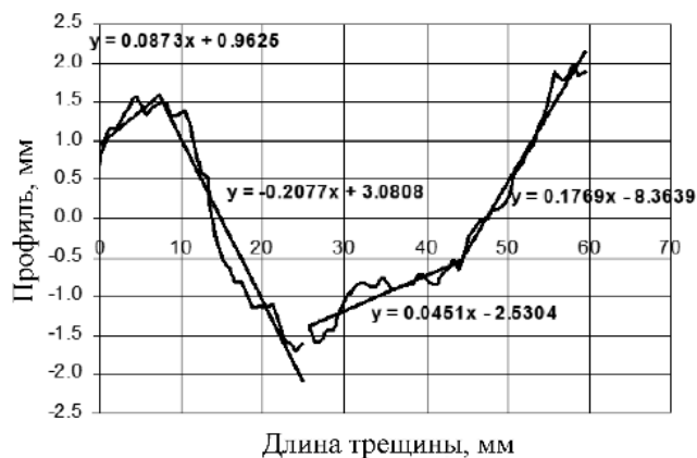
Рисунок 4. Аппроксимация участков линии извилистости кусочно-линейными функциями
