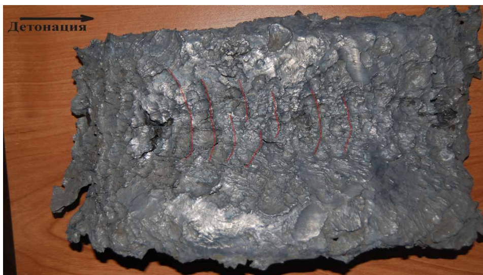
Рис. 1. Пластина-свидетель после взрыва
