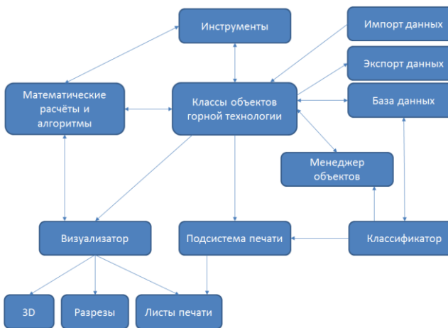
Рисунок 3 – Составные части и модули GEOTECH-3D.
