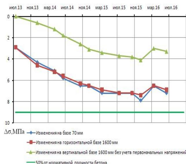
Рисунок 5 – График изменения напряжений в бетонной крепи ствола шахты «Клетевая» на горизонте -910м
