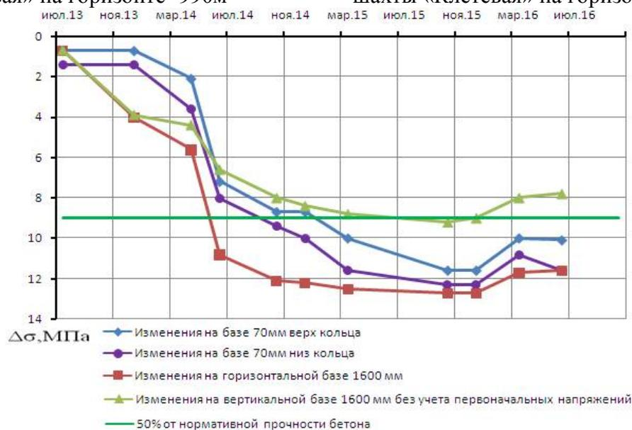
Рисунок 8 – График изменения напряжений в бетонной крепи ствола шахты «Клетевая» на горизонте -1390м
