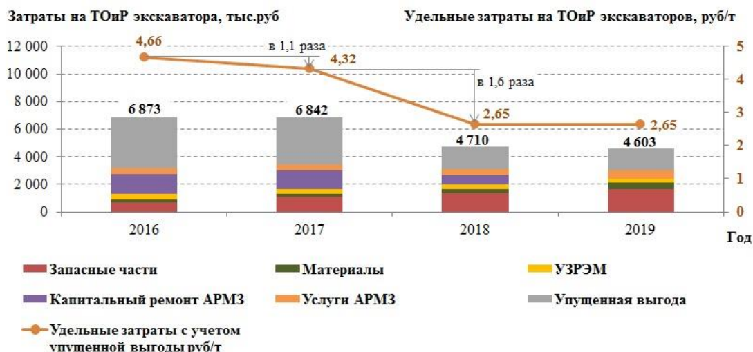
Рис. 4.30. Финансовые затраты на техническое обслуживание и ремонт (ТОиР) экскаваторов Рудоуправления ПАО «Ураласбест»
