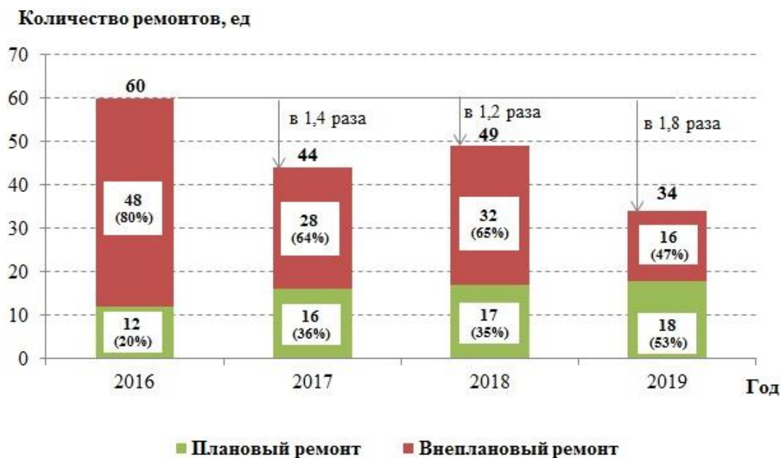
Рис. 4.16. Количество ремонтов преобразовательного агрегата экскаваторов Рудоуправления ПАО «Ураласбест»
