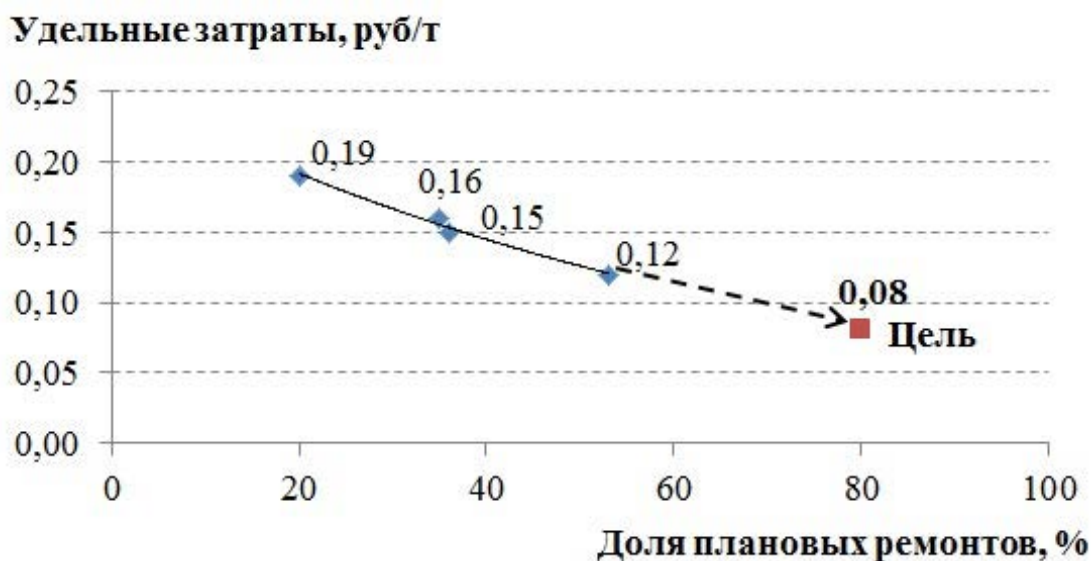
Рис. 4.20. Связь доли плановых ремонтов преобразовательного агрегата и удельных затрат на его ремонтное обслуживание
