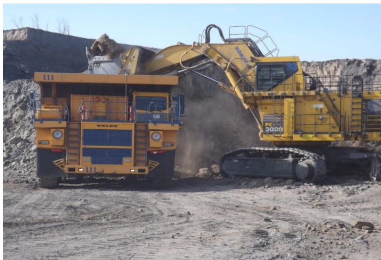
Рис. 5.5. Погрузка автосамосвала гидравлическим экскаватором РС-3000
