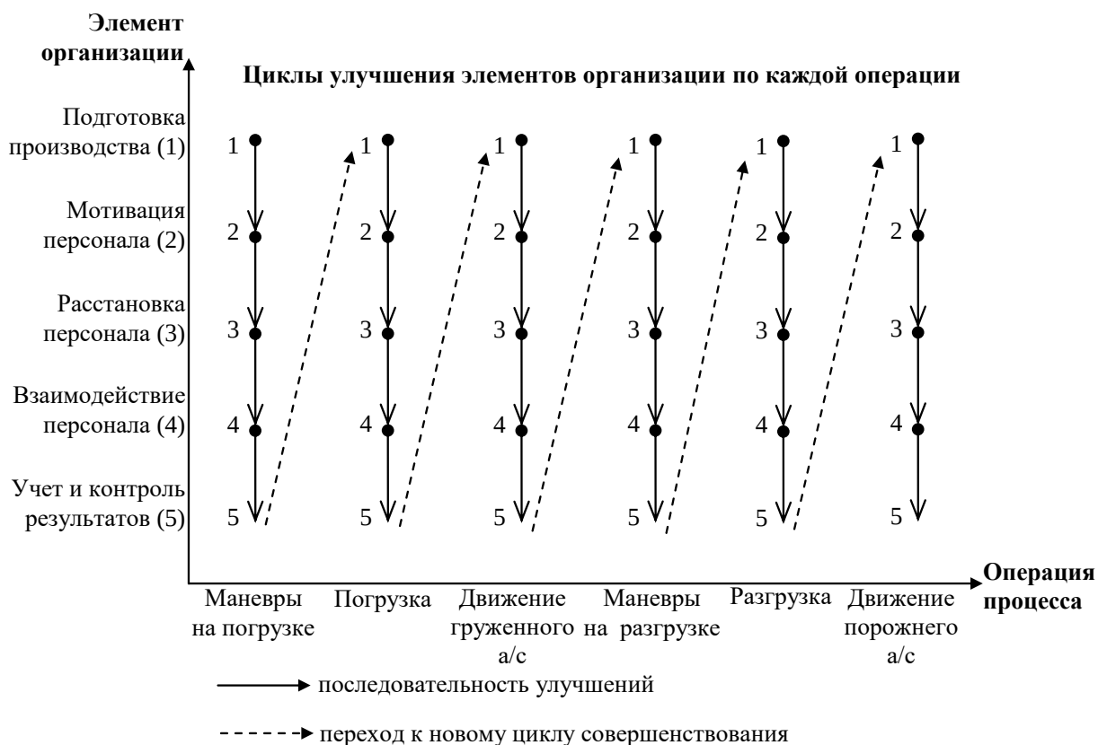
Рис. 2.3. Схема модели трансформации производственного процесса (на примере процесса транспортирования горной массы автосамосвалами)
