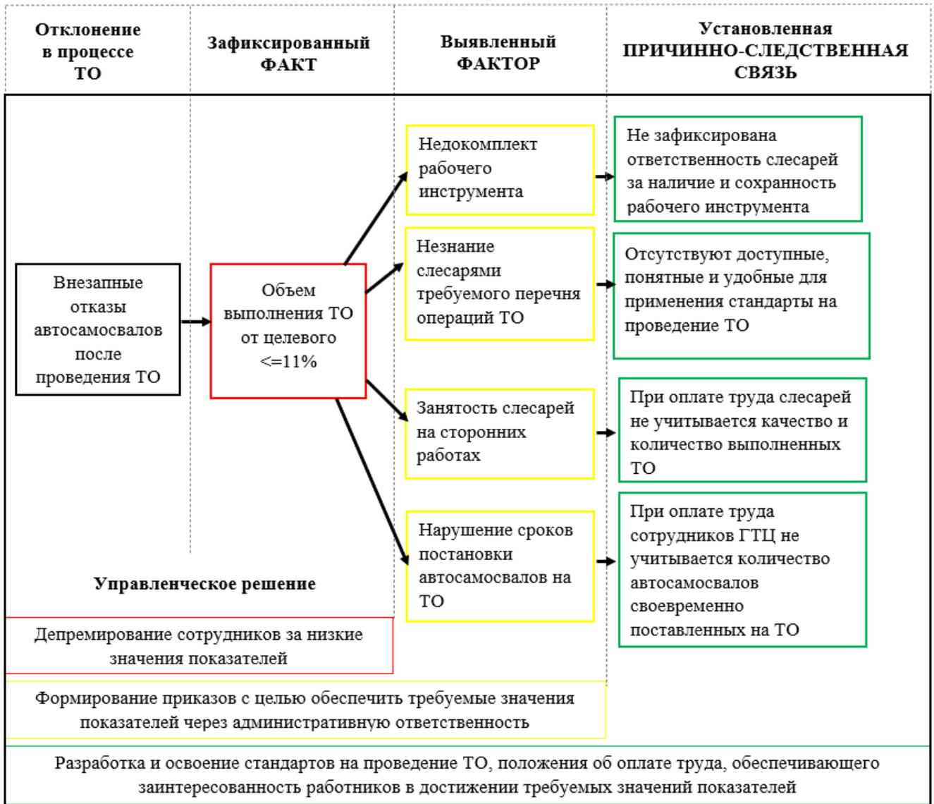
**Рисунок 4 – Результаты мониторинга процесса технического обслуживания автосамосвалов БелАЗ-7513 и 75306 на разрезе «Черногорский»**
