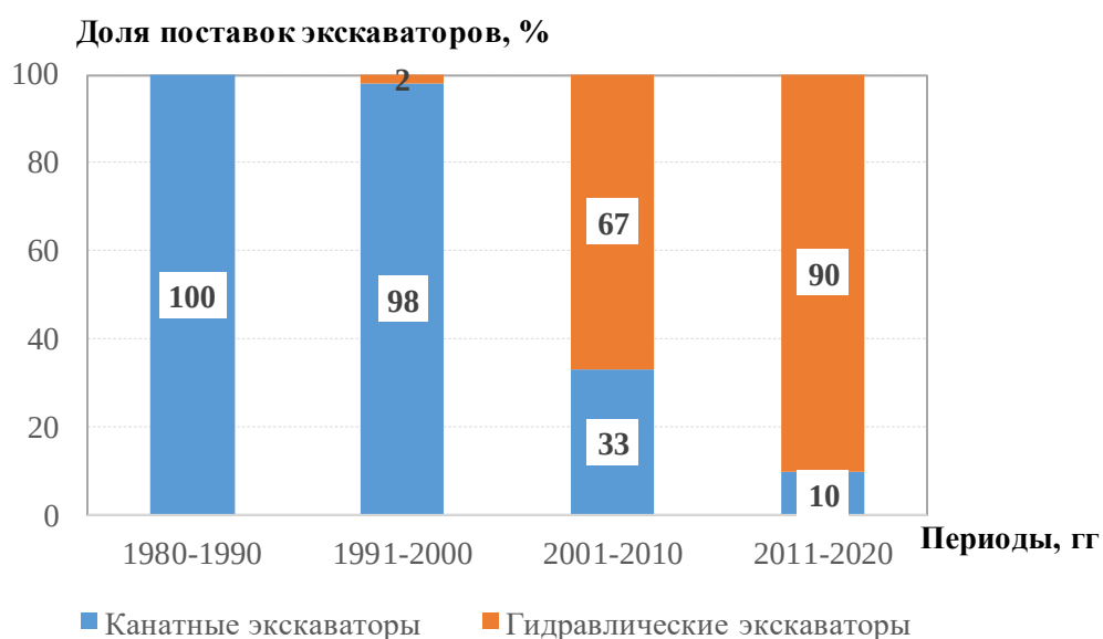
Рис.1.2. Доля мировых поставок канатных и гидравлических экскаваторов по периодам 1980-2020 гг.
