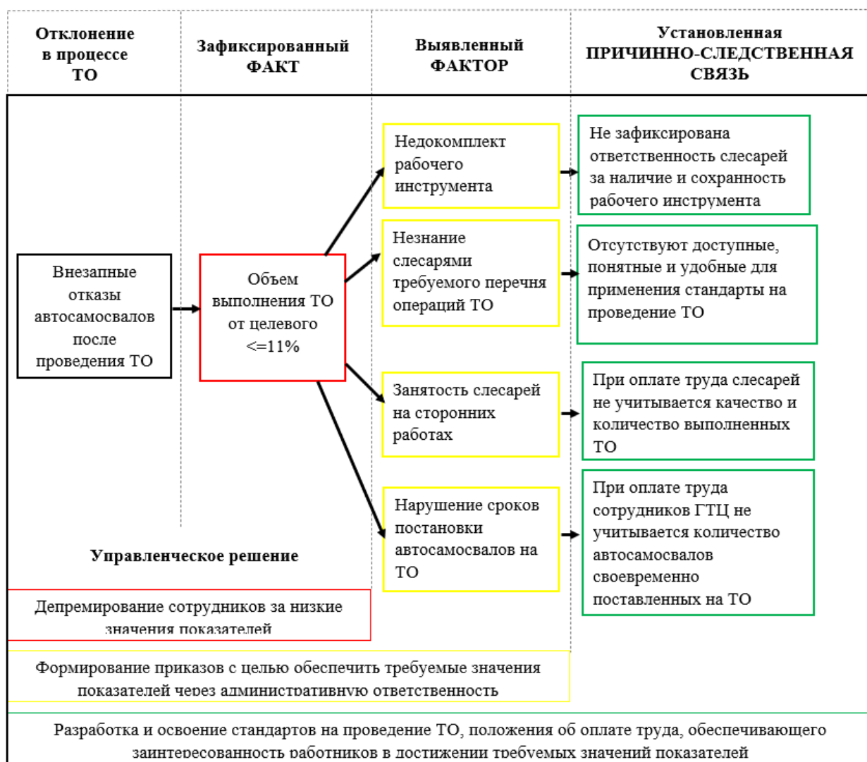
Рис. 2.1. Результаты мониторинга процесса технического обслуживания автосамосвалов БелАЗ-7513 и 75306 на разрезе «Черногорский»
