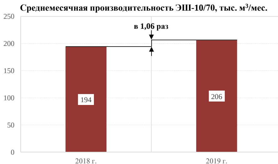
Рис. 3.21. Изменение производительности экскаваторов ЭШ-10/70 за 2018-2019 гг.
