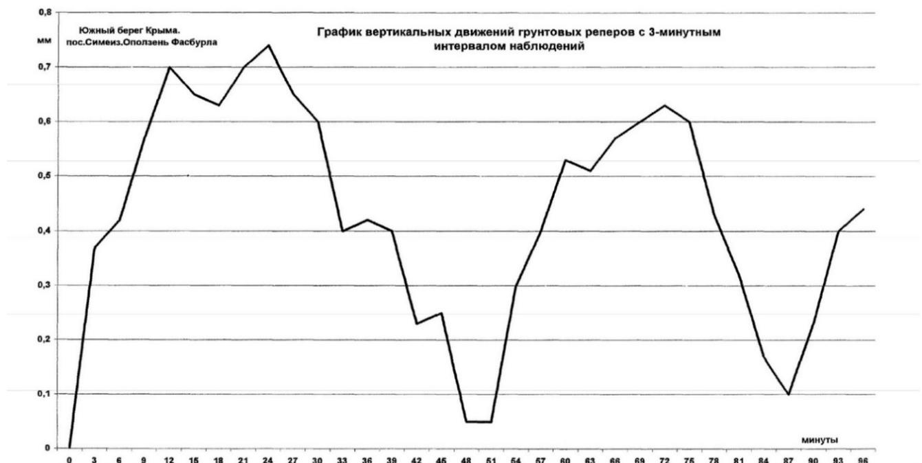
Рисунок 1.4 – График вертикальных движений грунтовых реперов с 3-минутным интервалом наблюдений с точностью измерений 0,05 мм [63]
