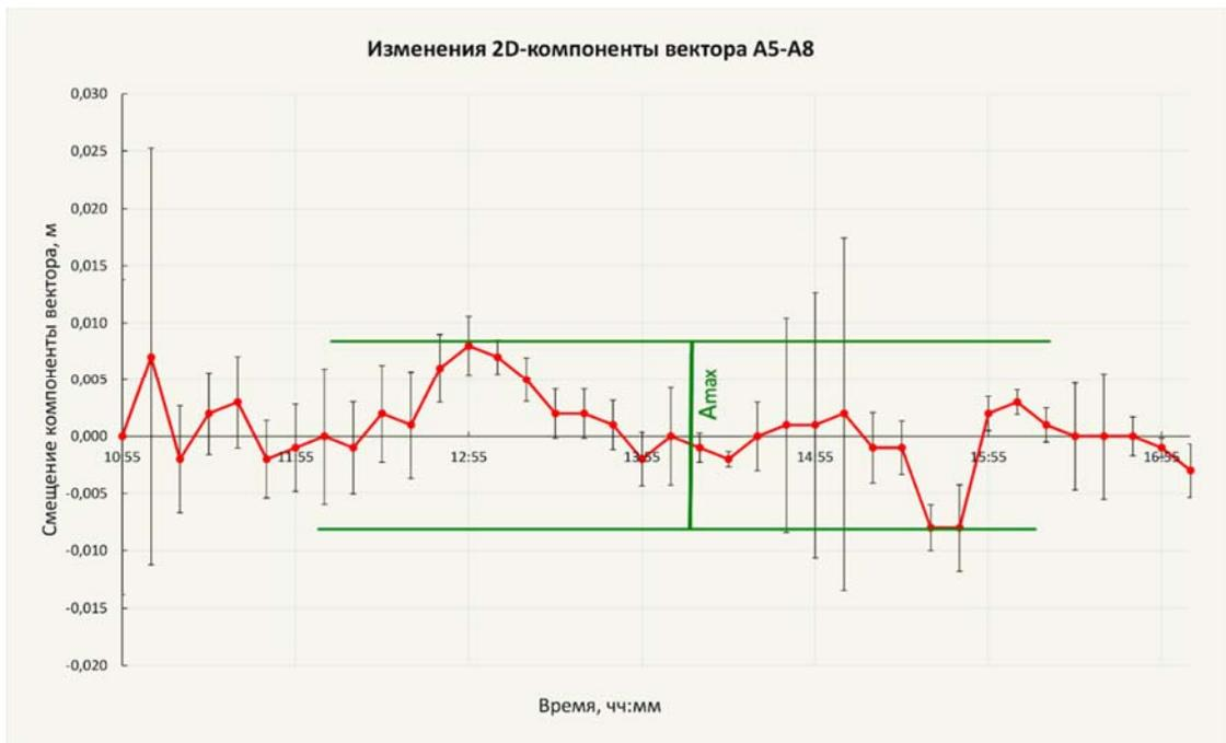
Рисунок 3.9 – Пример определения максимального значения амплитуды (размаха) смещений на графике
