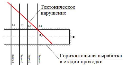
Рисунок 2 – План моделируемых положений тектонического нарушения относительно профиля выработки
