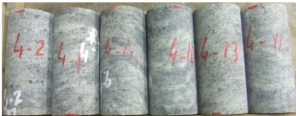
Рис. 2.3. Образцы линзовидно-полосчатой апатит-нефелиновой руды, подготовленные для проведения испытаний при одноосном сжатии
