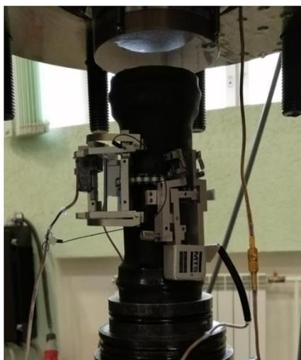
Рис. 4.3. Образец, подготовленный для испытаний в условиях трехосного сжатия
