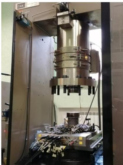
Рис. 4.2. Сервогидравлическая испытательная установка MTS 815
