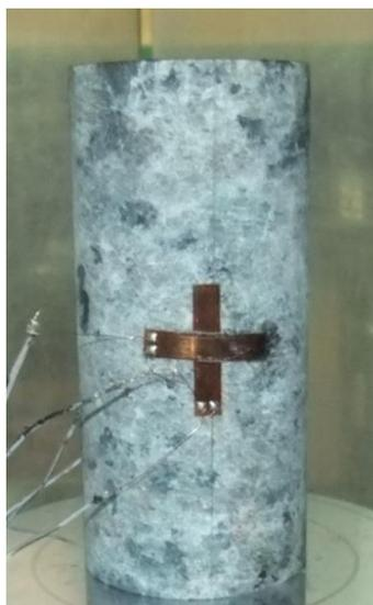
Рис. 2.6. Расположение тензодатчиков на образце пятнисто-линзовидно-полосчатой апатит-нефелиновой руды для определения величин деформаций при нагружении в условиях одноосного сжатия
