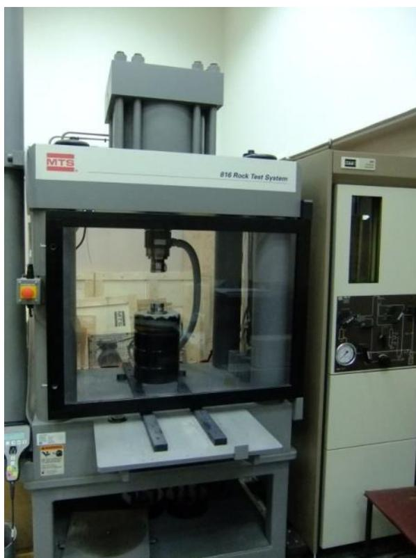
Рис. 2.4. Комплексная испытательная установка MTS 816 Rock Test System
