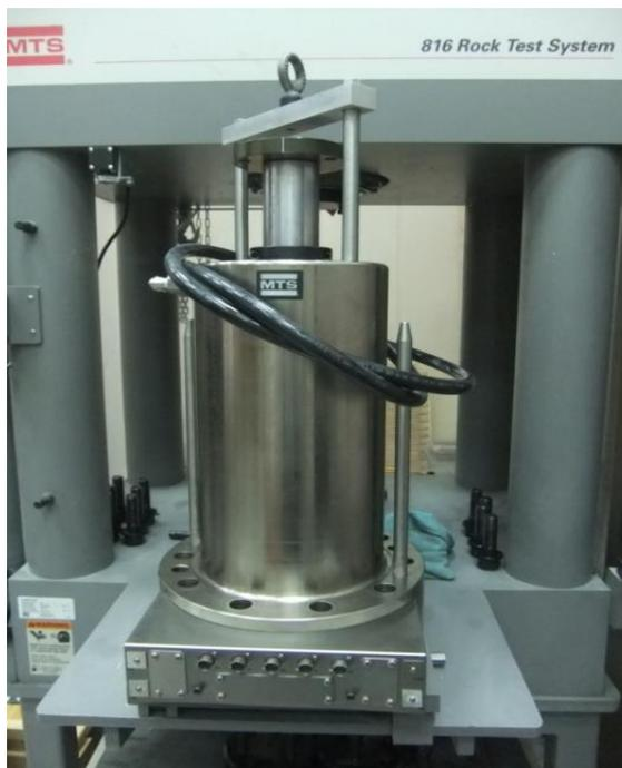
Рис. 2.9. Комплексная испытательная установка MTS 816 Rock Test System в конфигурации для проведения испытаний при трехосном сжатии
