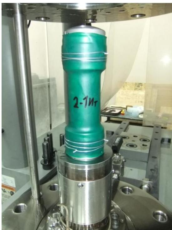
Рис. 2.10. Образец, подготовленный для проведения испытаний при трехосном сжатии
