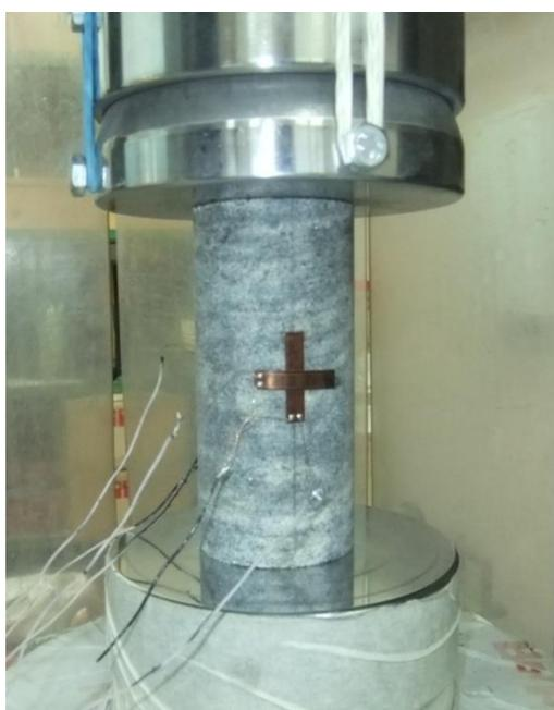
Рис. 2.5. Образец, подготовленный для проведения испытаний при одноосном сжатии
