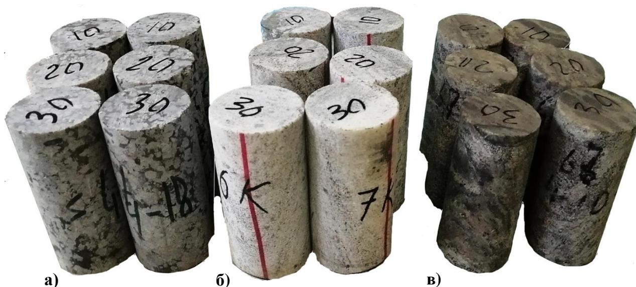
Рис. 4.1. Образцы исследуемых скальных горных пород: а) уррита среднезернистого массивного, б) кальцитового карбонатита, в) линзовидно-полосчатой апатит-нефелиновой руды
