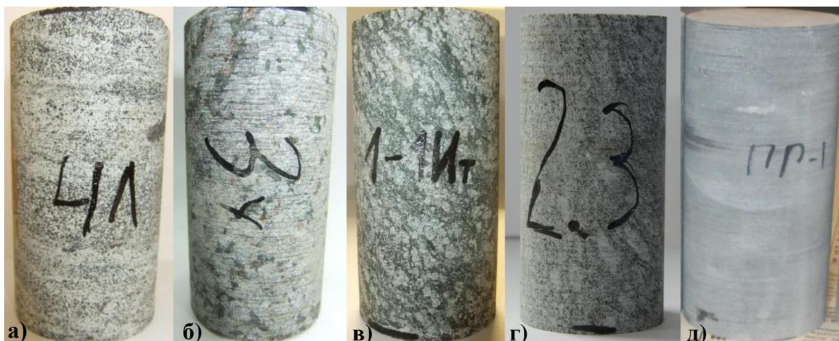
Рис. 2.19. Образцы исследуемых скальных горных пород: а) линзовидно-полосчатой апатит-нефелиновой руды, б) уррита среднезернистого массивного, в) ийолита трахитоидного, г) гнейса серого лейкократового; д) туфогенно-осадочной породы
