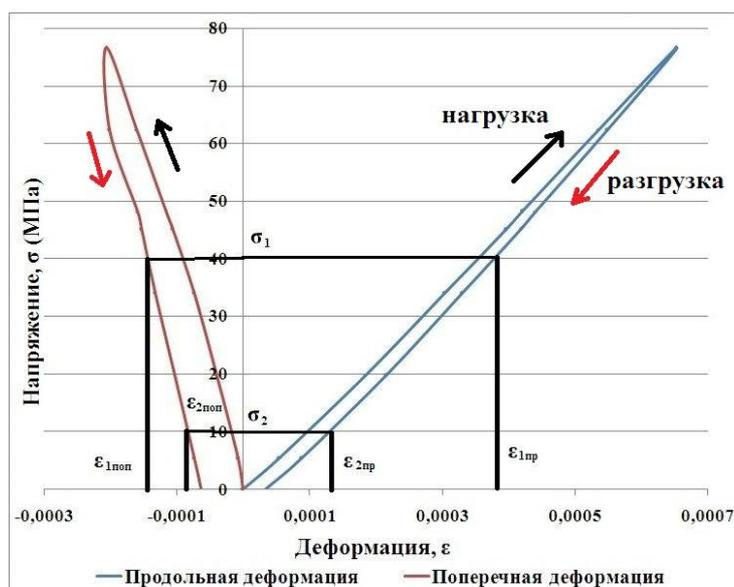
Рис. 2.7. Пример графика зависимости значений напряжения от величин продольных и поперечных деформаций, построенный для образцов скальных горных пород Хибинского массива
