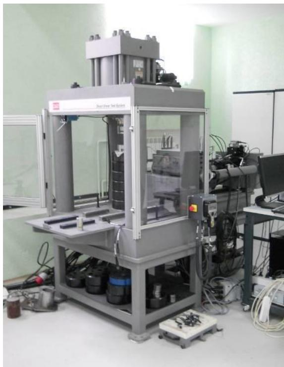
Рис. 3.7. Сервогидравлическая испытательная установка MTS 816 с повышенной жесткостью в конфигурации на одноосное сжатие
