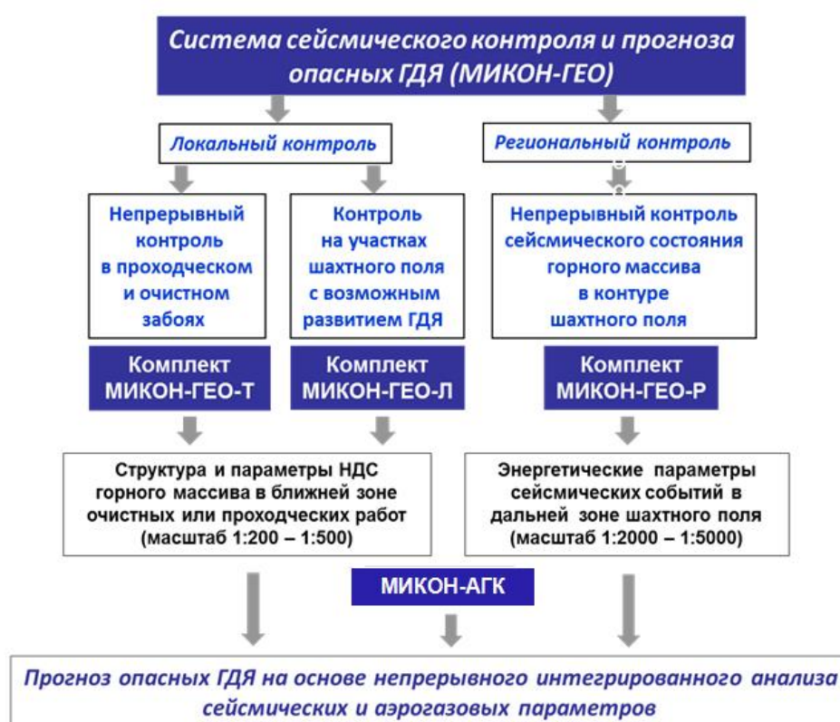
Рисунок 3.13 – Схема системы сейсмического контроля и прогноза развития опасных ГДЯ «Микон-ГЕО» с учетом системы аэрогазового контроля атмосферы выработки «Микон-АГК»
