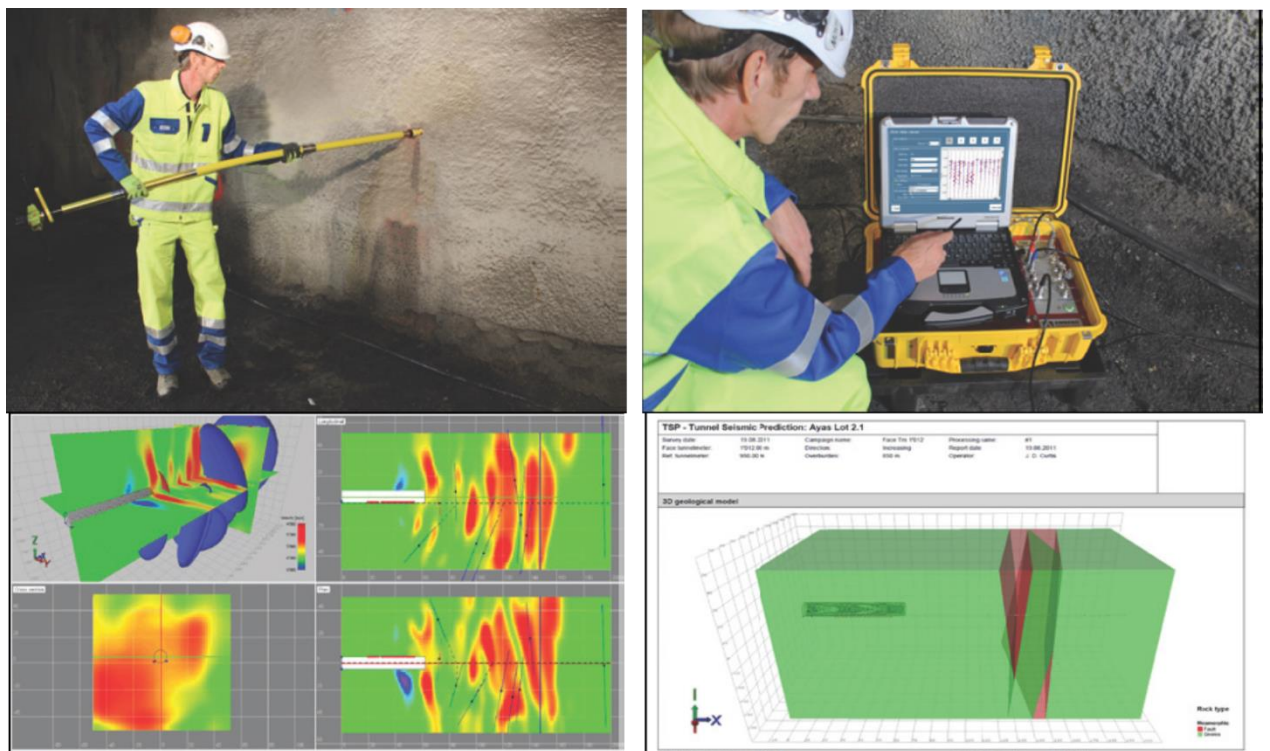
Рисунок 1.10 – Схема наблюдений и результаты по методу TSP 303 а – установка 3С геофона на анкере в шпур 2 м; б – система регистрации; с – объемные и плоские изображения поля сигналов отраженных волн; д – геологическая модель с зоной разлома
