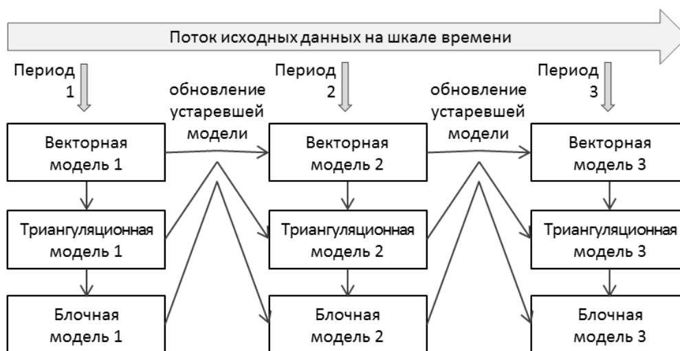
Рисунок 3.45 – Связь векторных, триангуляционных и блочных моделей при их обновлении в течение срока существования
