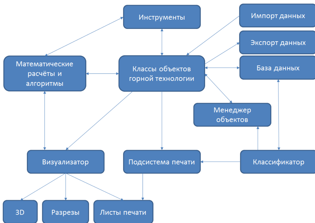
Рисунок 2.3 – Схема взаимодействия модулей графического редактора GEOTECH-3D
