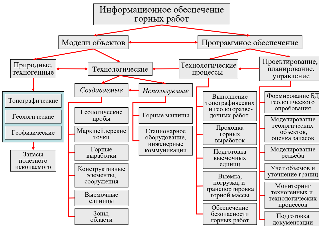
Рисунок 2.2 – Структурные связи системы информационного обеспечения горных работ
