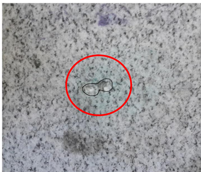
Рисунок 3.19 – Область разрушения, полученная при энергии удара 64 Дж
