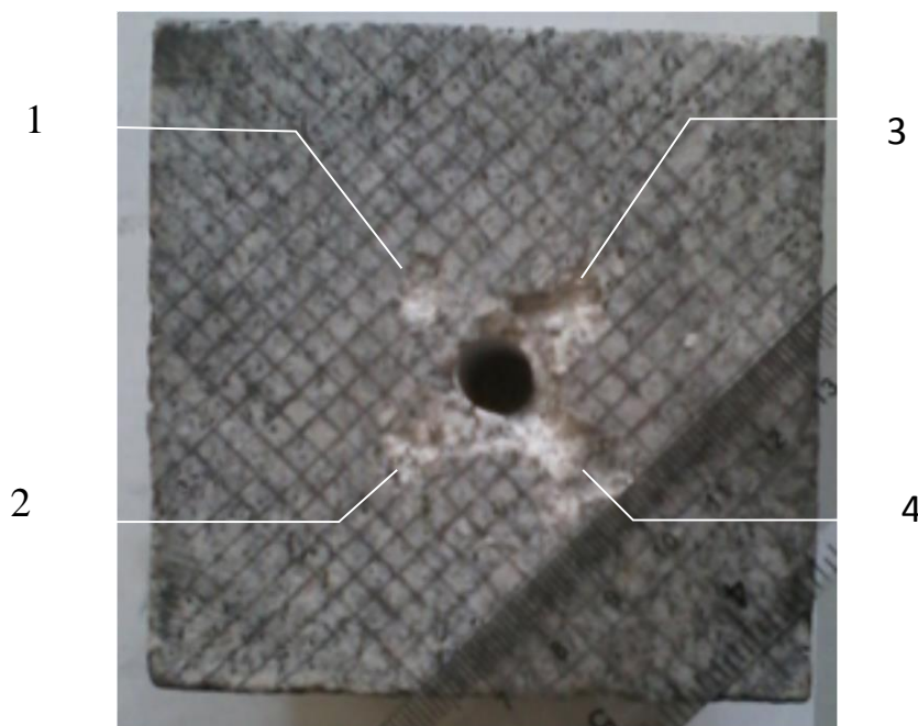
Рисунок 3.31 – Разрушение гранита при расстоянии 1d относительно свободной поверхности
