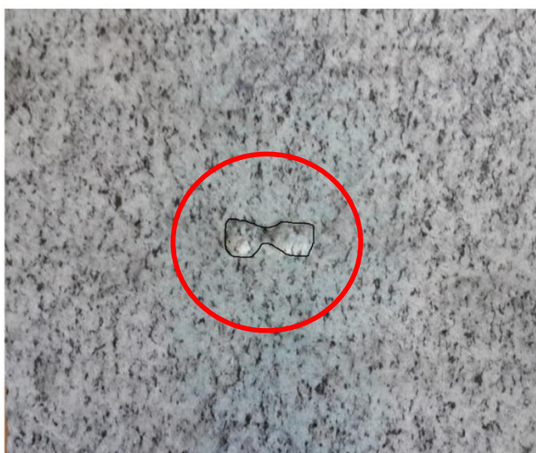
Рисунок 3.22 – Область разрушения породы, полученная при энергии удара 80
