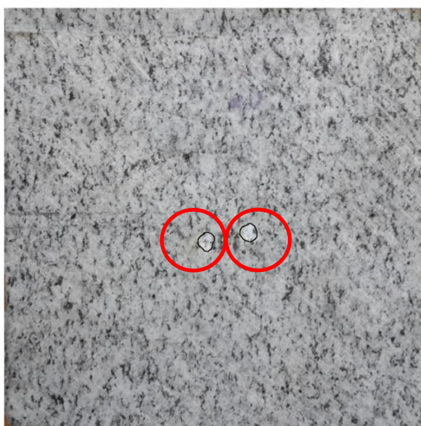
Рисунок 3.14 – Лунки разрушения, полученные при энергии удара 32 Дж
