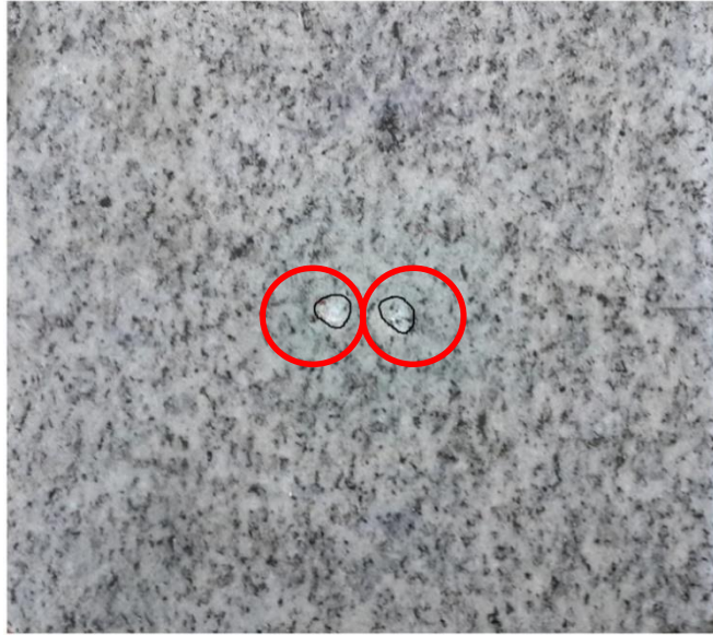
Рисунок 3.16 – Лунки разрушения, полученные при энергии удара 48 Дж
