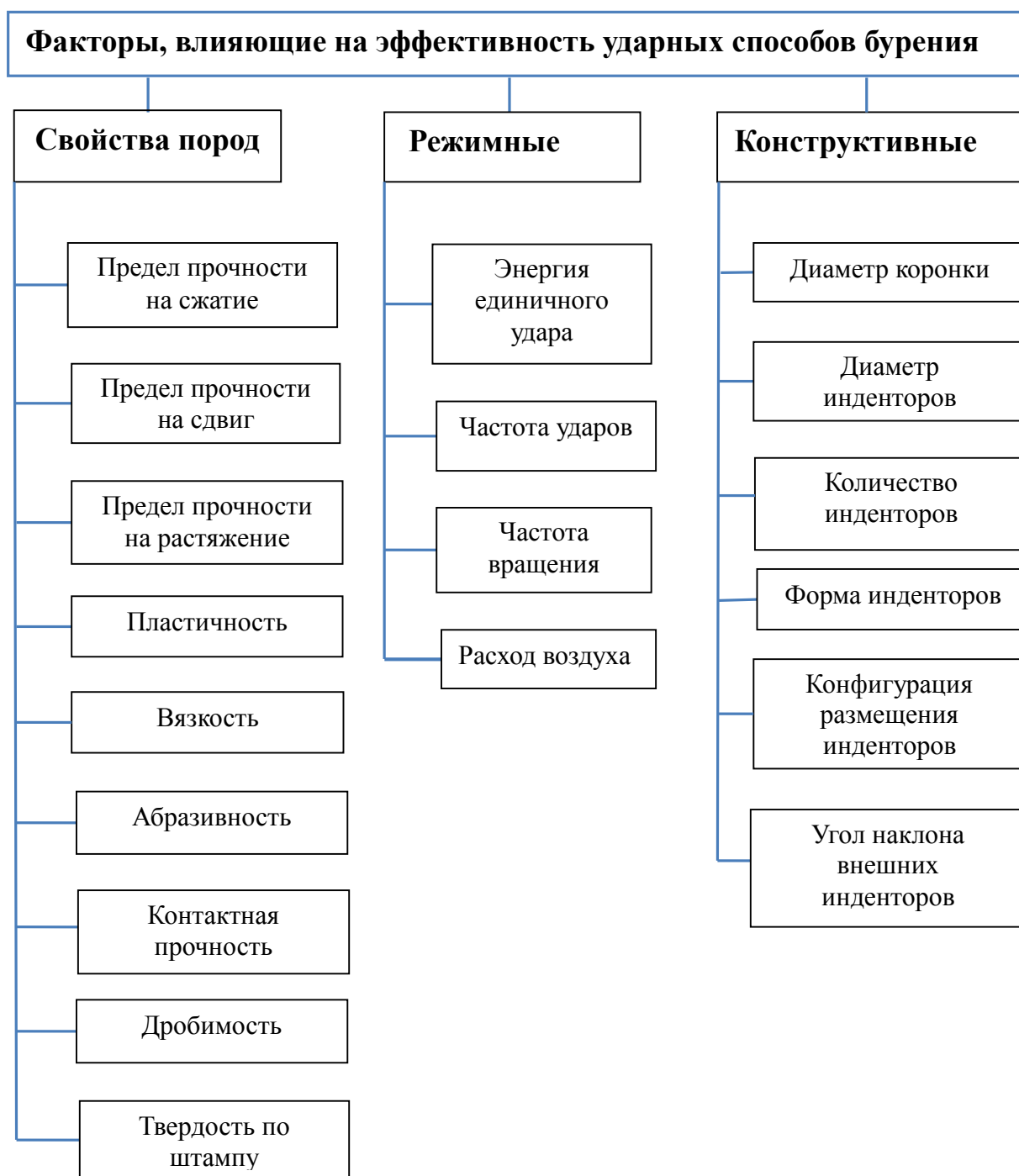
Рисунок 1.6 – Группы факторов, влияющих на эффективность разрушения породы при ударно-поворотном способе бурения
