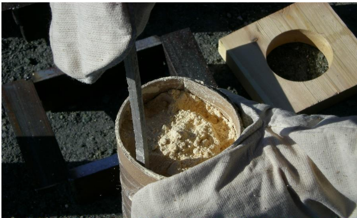
Рисунок 4.4 – Заполнение свободных промежутков Аммонитом 6 ЖВ.
