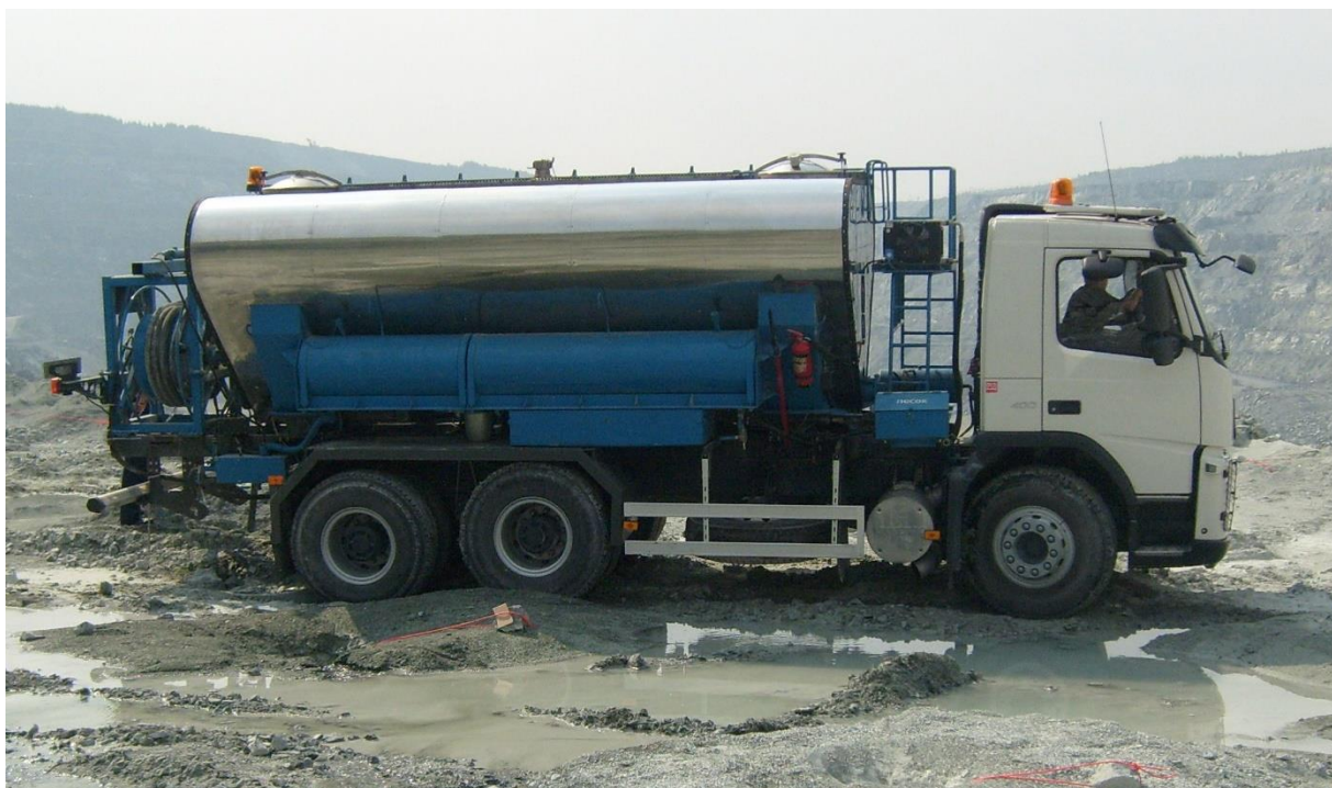
Рисунок 1.7 – Смесительно-зарядная машина МЗВ-15 для изготовления порэмита 1А
