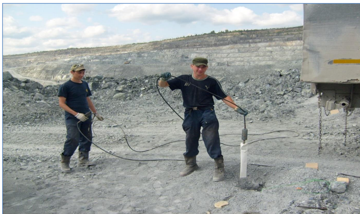
Рисунок 3.7 – Установка пневматического затвора в скважину перед формированием верхнего скважинного заряда
