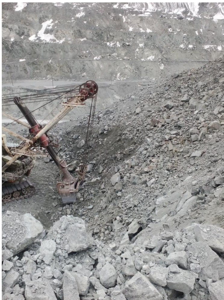
Рисунок 3.14 – Блок, взорванный с применением Порэмита 1А с добавлением NaCl
