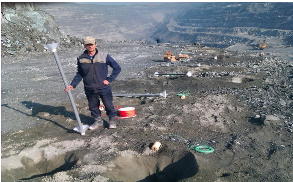
Рисунок 3.6 – Устройство (заглушка) скважинного перебура
