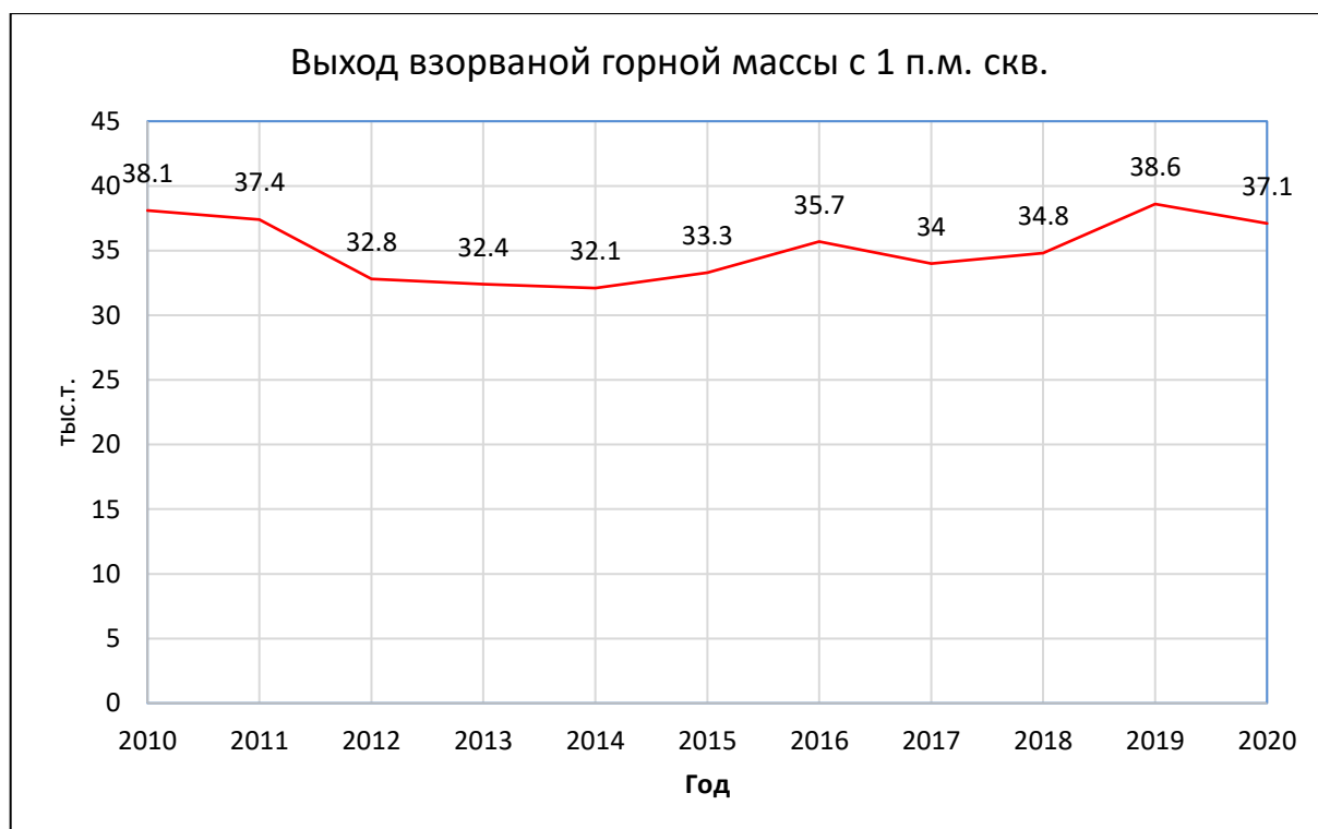
Рисунок 2.3 – Выход взорванной горной массы с 1 п.м. скважины диаметром 230-245 мм на Баженовском месторождении хризотил-асбеста в 2010-2020 гг.
