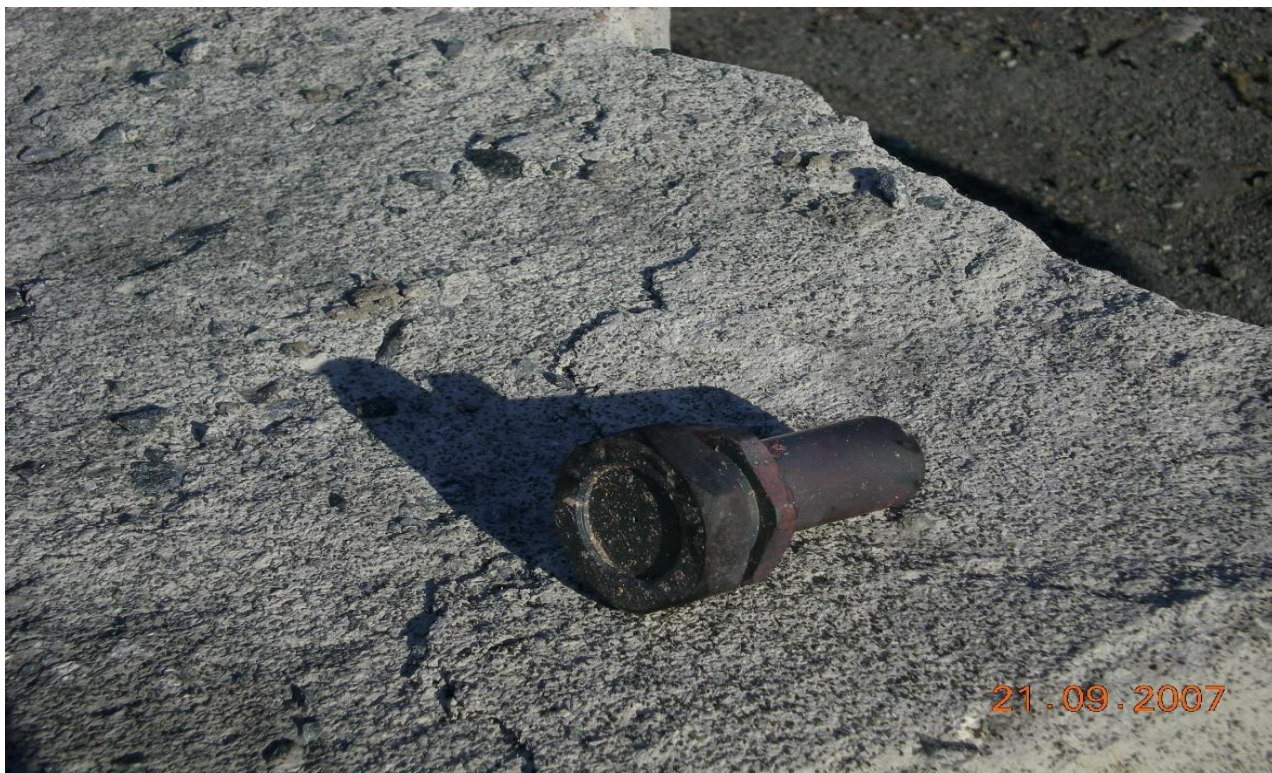
Рисунок 4.9 – Трубка с калибровочным отверстием 1 мм после испытания
