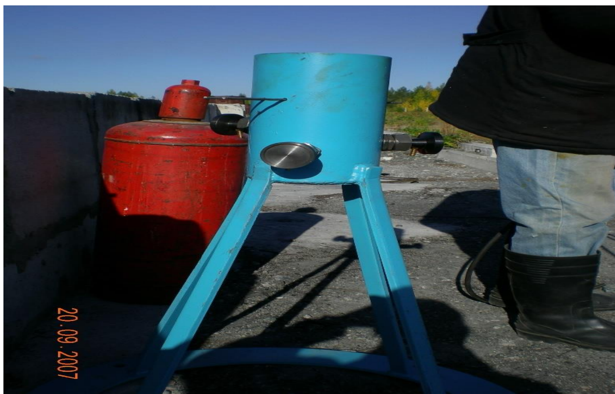
Рисунок 4.8 – Защитный сварной ящик с горелками
