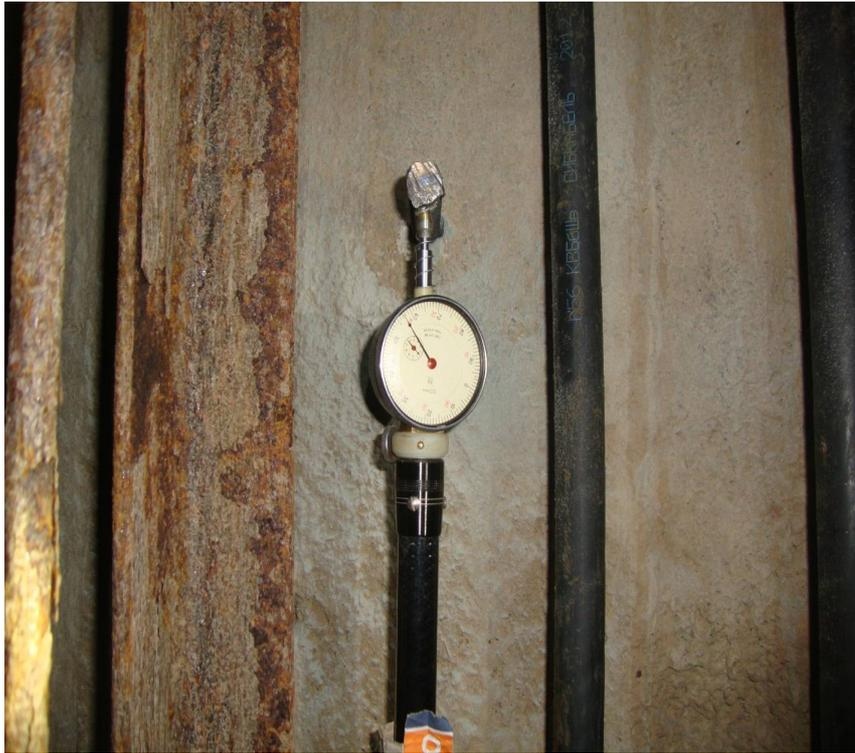
Рисунок 3.14 – Измерения вертикальных деформаций в крепи ствола шахты «Клетевая» на базе 1600 мм
