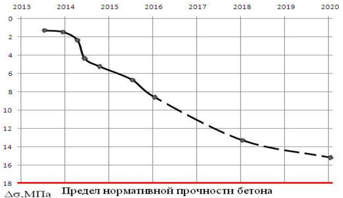
Рисунок 3.22 – График прогнозного изменения средних напряжений во времени в бетонной крепи ствола шахты «Клетевая»
