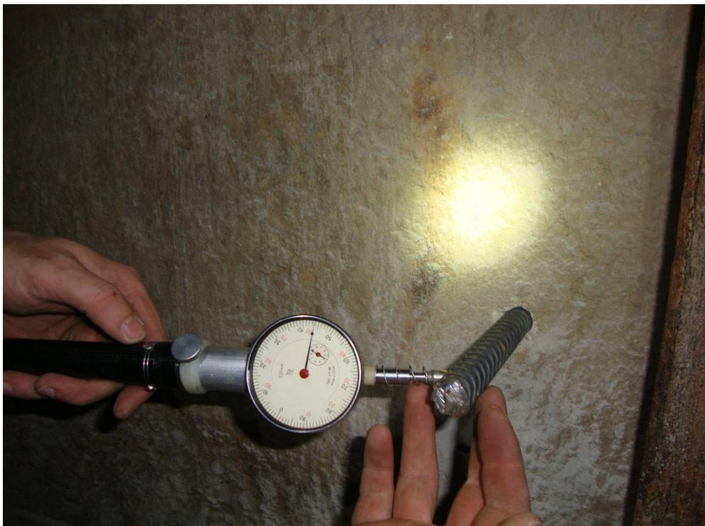
Рисунок 3.13 – Измерения горизонтальных деформаций в крепи ствола шахты «Клетевая» на базе 1600 мм
