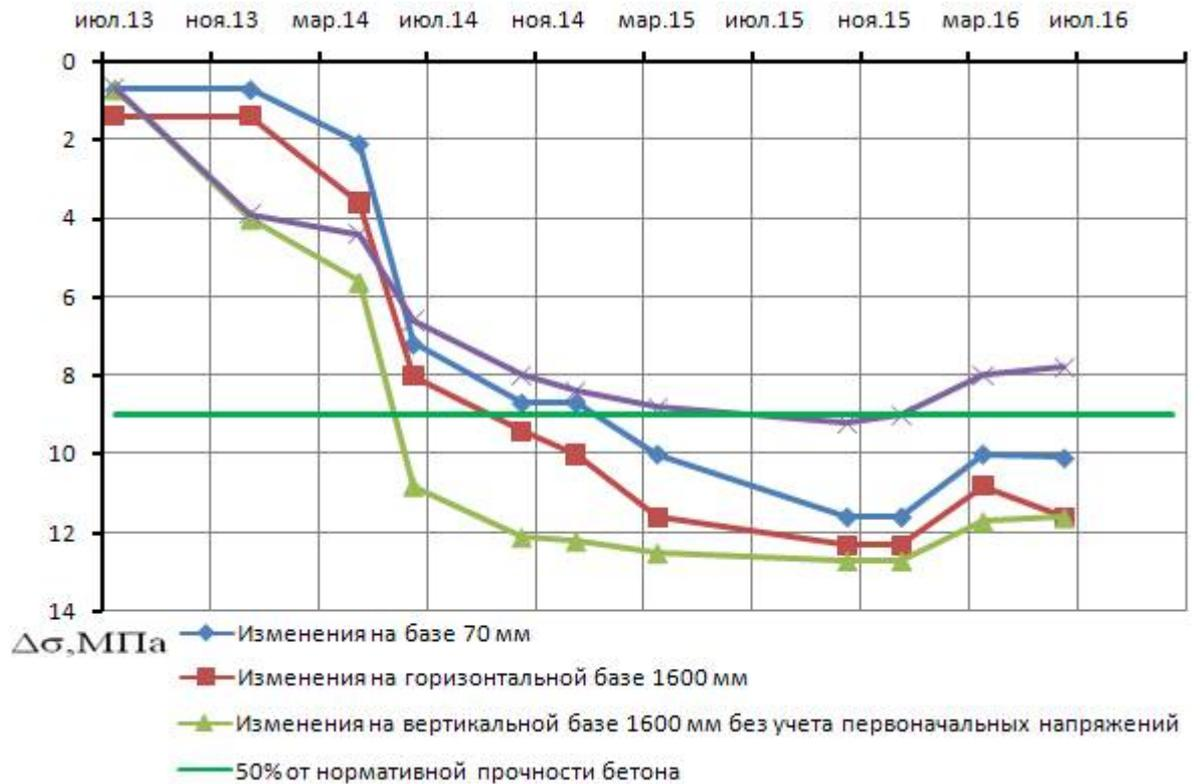
Рисунок 3.20 – График изменения напряжений в бетонной крепи ствола шахты «Клетевая» на горизонте -1390м
