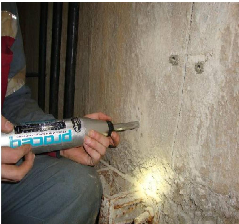
Рисунок 3.12 – Определение прочности бетона склерометрическим неразрушающим методом
