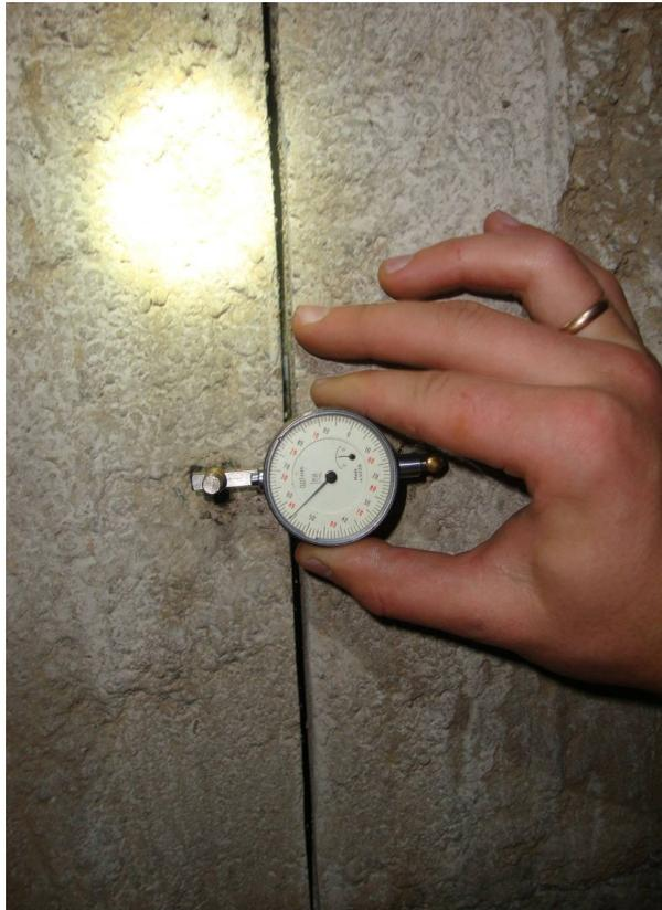
Рисунок 3.15 – Измерения деформации во времени в крепи ствола шахты «Клетевая» на базе 70 мм
