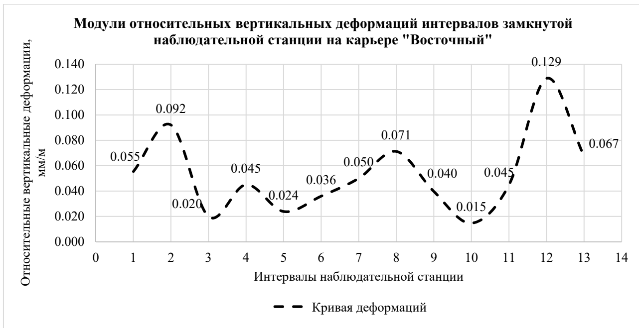
Рисунок 9 – Относительные вертикальные деформации на карьере «Восточный»
