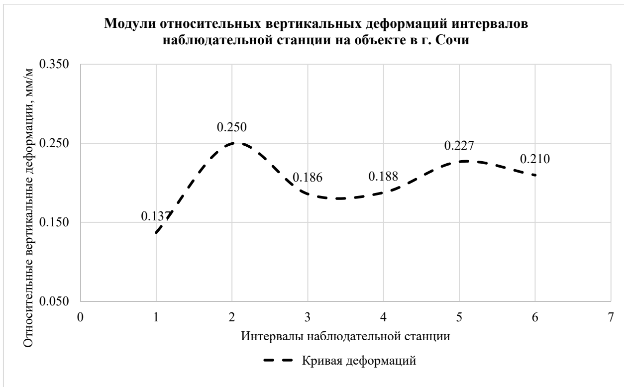
Рисунок 11 – Относительные вертикальные деформации на объекте в г. Сочи
