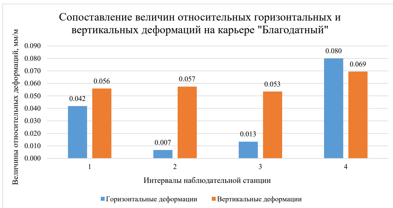
Рисунок 13 – Сопоставление величин относительных горизонтальных и вертикальных деформаций на карьере «Благодатный»
