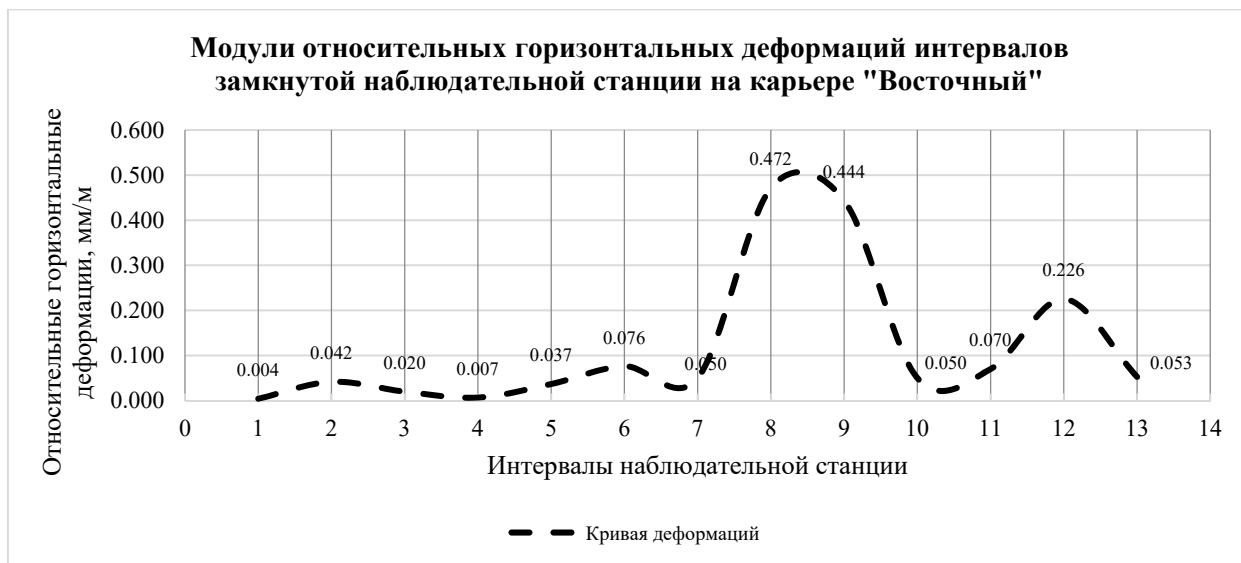
Рисунок 4 – График средних значений модулей относительных горизонтальных деформаций на карьере «Восточный»
