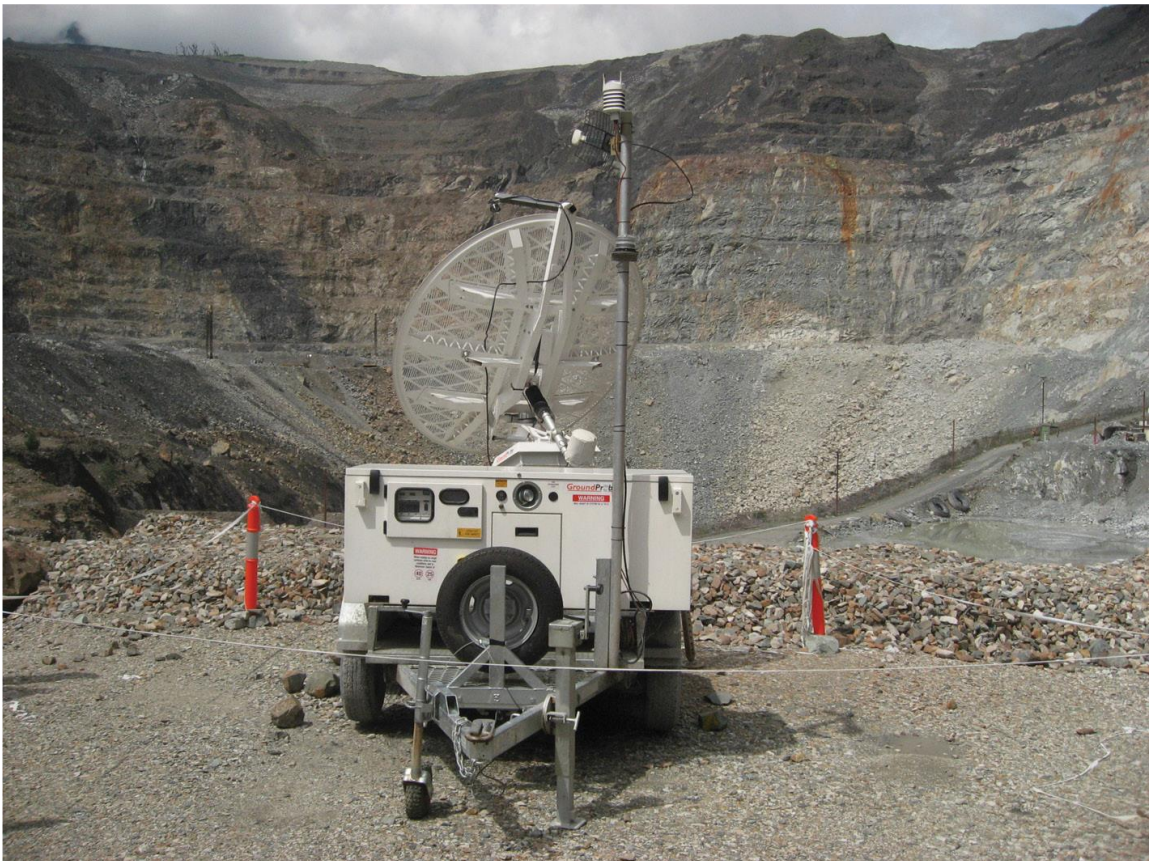
Рисунок 1.7 – Радарная станция для мониторинга устойчивости борта карьера
