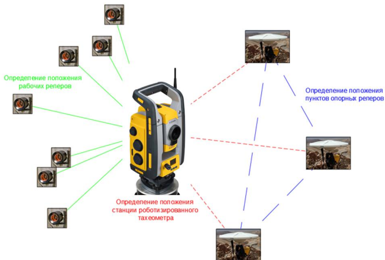
Рисунок 3.14 – Принципиальная схема разработанной методики мониторинга на этапе производства измерений
