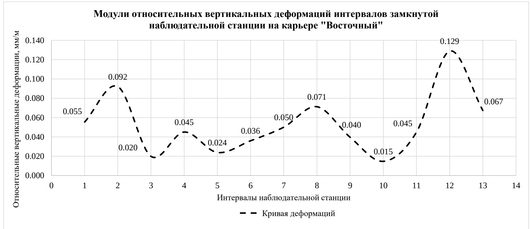
Рисунок 4.29 – График средних значений модулей относительных вертикальных деформаций на наблюдательной станции на карьере «Восточный»
