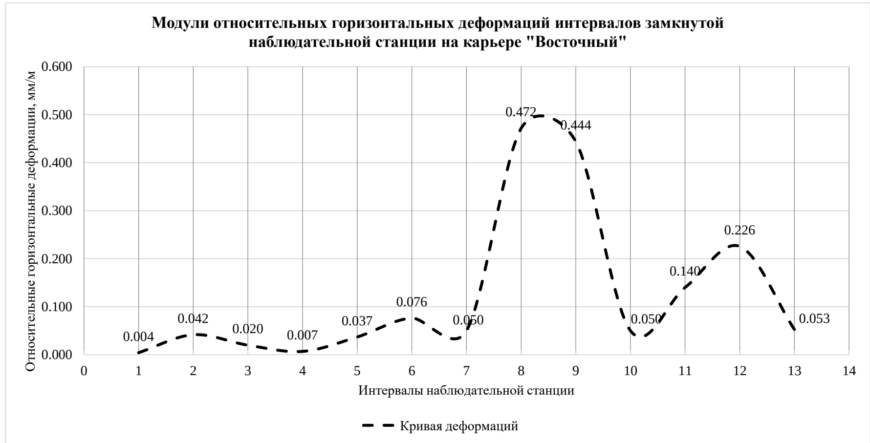
Рисунок 4.22 – График средних значений модулей относительных горизонтальных деформаций на наблюдательной станции карьера «Восточный»
