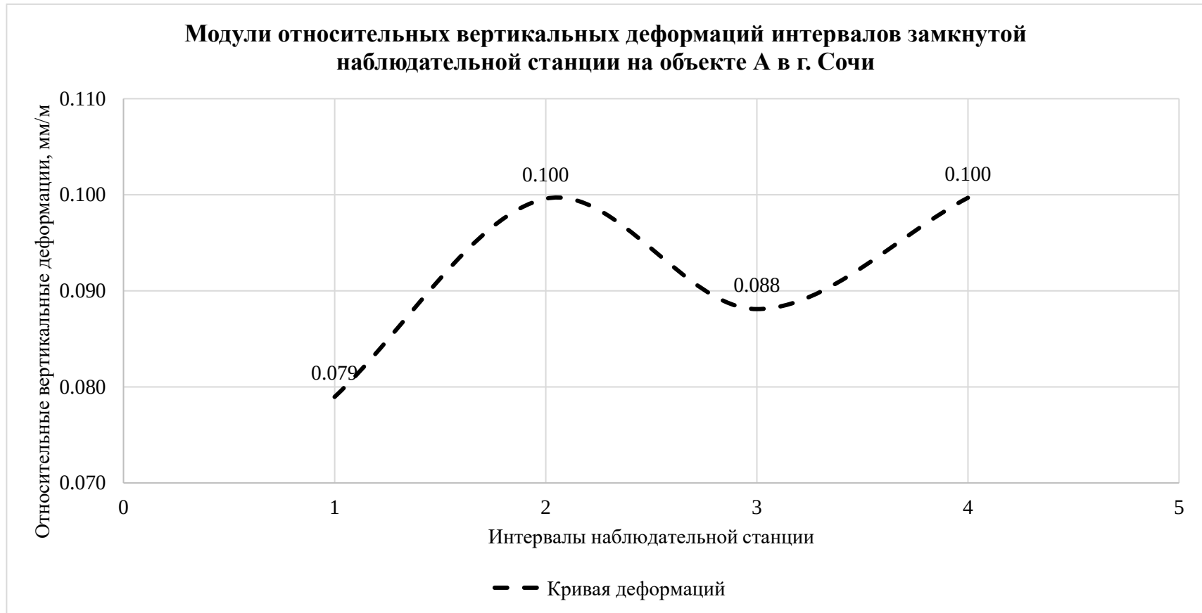
Рисунок 4.27 – График средних значений модулей относительных вертикальных деформаций на наблюдательной станции на объекте А в г. Сочи
