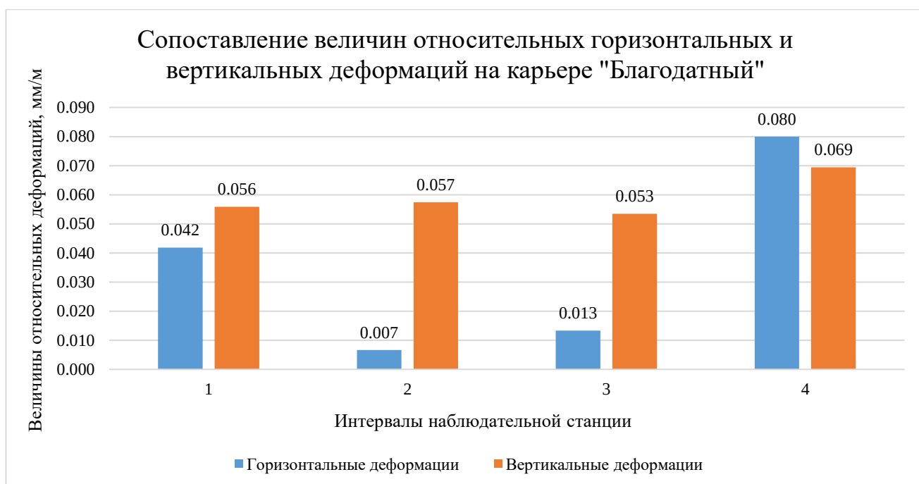
Рисунок 4.34 – Сопоставление горизонтальных и вертикальных деформаций на Благодатнинском месторождении
