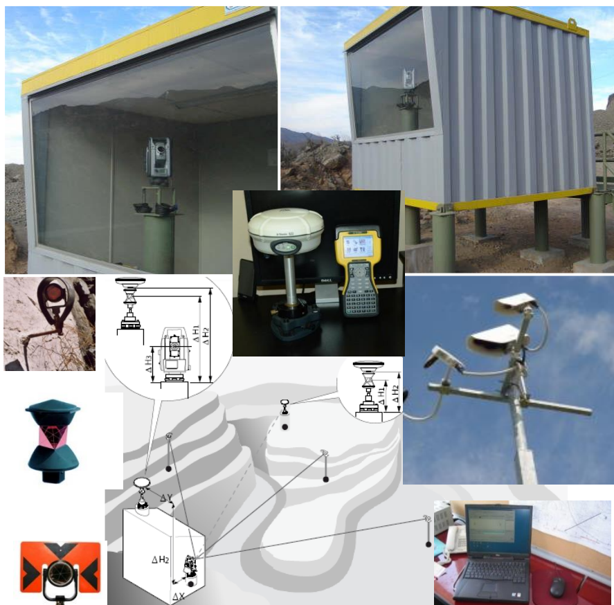
Рисунок 1.5 – Обзорный вид автоматизированной станции (АСДМ), включающий: укрытие для защиты; метеостанцию (для ввода поправок в тахеометр); компьютер для обработки данных мониторинга; GNSS приемник (для корректировки по позиционированию АСДМ); реперы с отражательными призмами (в различных вариантах исполнения и типах установки и крепления)
