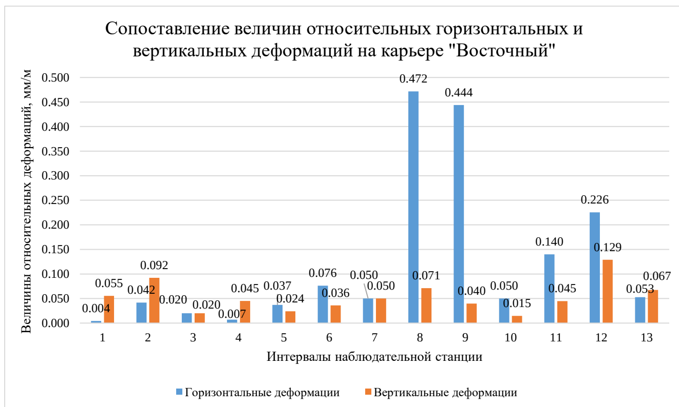
Рисунок 4.33 – Сопоставление горизонтальных и вертикальных деформаций на Олимпиадинском месторождении
