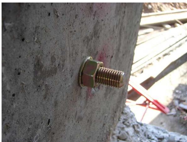
Рисунок 4.10 – Применяемая на опытно-промышленных объектах конструкция рабочего репера
