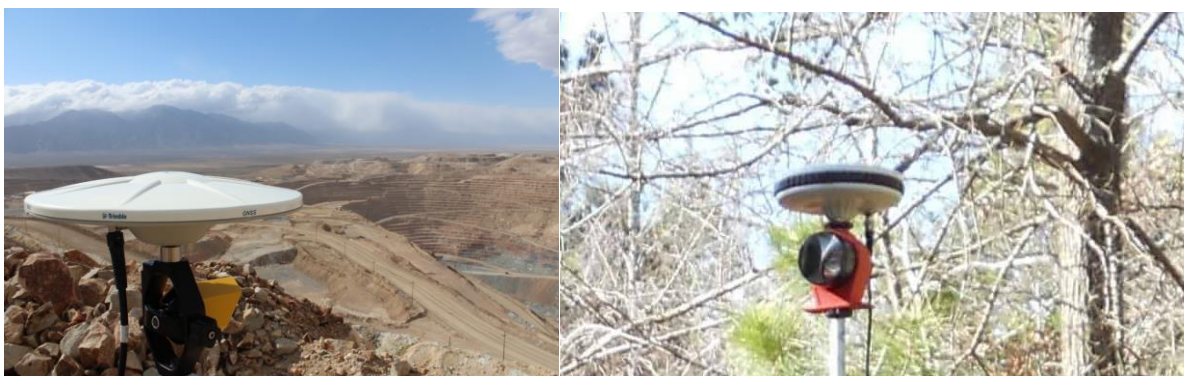
Рисунок 3.8 – Вариант единовременного размещения отражателя и GPS-антенны над пунктом опорной сети
