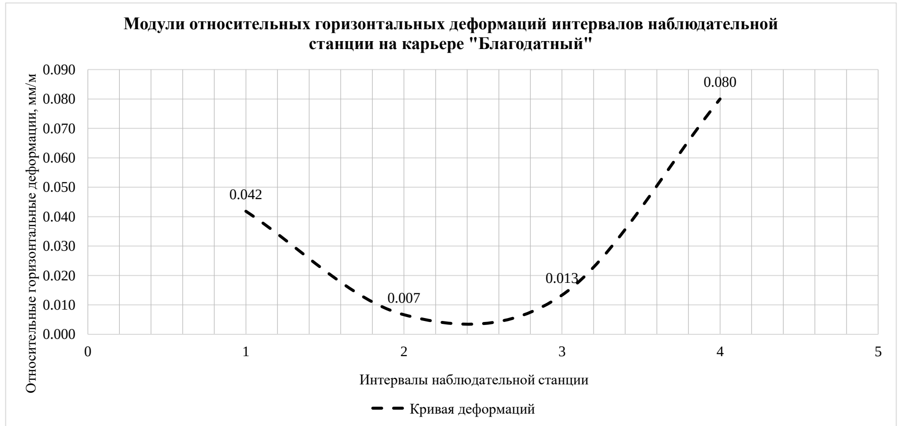
Рисунок 4.25 – График средних значений модулей относительных горизонтальных деформаций на наблюдательной станции карьера «Благодатный»
