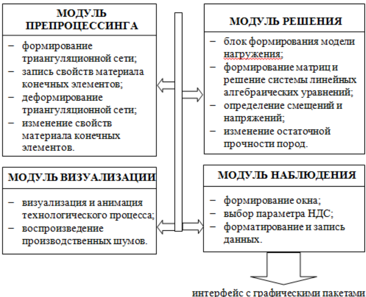
Рисунок 54. Метод прогноза параметров геомеханического взаимодействия механизированных крепей с углепородным массивом на базе программно – технического комплекса
