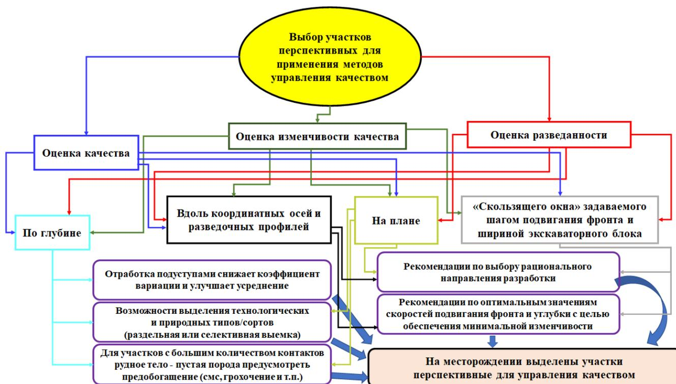
Рисунок 2.12 – Блок-схема экспресс-оценки вариабельности качества по глубине оруденения, по простиранию и вкрест простирания залежи с выделением «скользящего окна»
