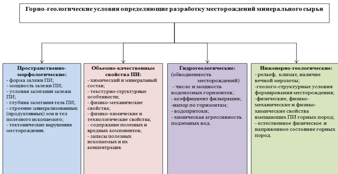
Рисунок 1.2 – Систематизация горно-геологических условий определяющих разработку месторождений полезных ископаемых
