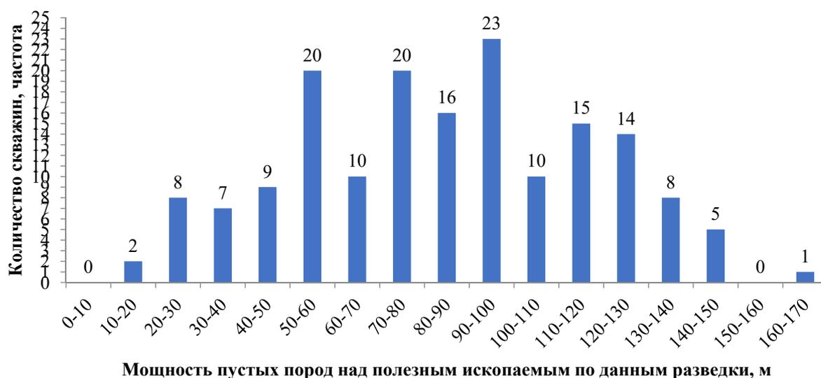
Рисунок 2.7 – Глубина подсечения разведочными скважинами полезного ископаемого на Серовском месторождении комплексных руд.
