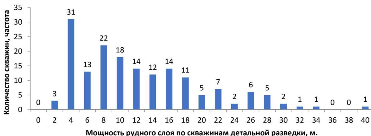
Рисунок 2.8 – Распределение мощностей рудных интервалов по данным анализа геологической базы данных на Серовском месторождении комплексных руд.
