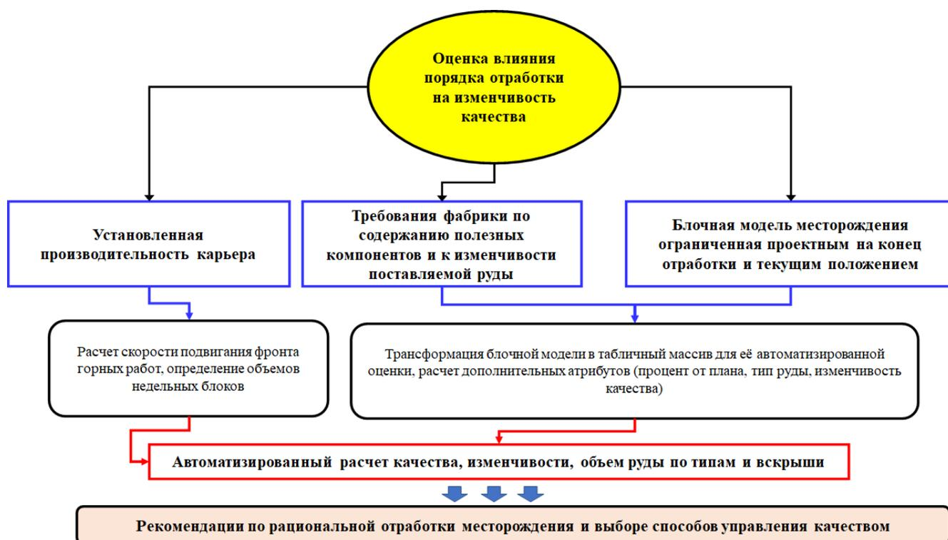
Рисунок 2.24 – Алгоритм расчета скорости подвигания фронта
