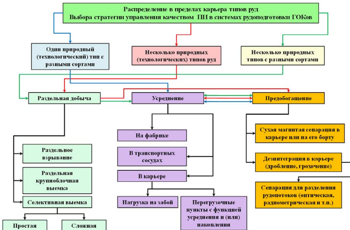
Рисунок 2 – Блок-схема применения способов управления качеством руды в зависимости от количества природных (технологических) типов и сортов
