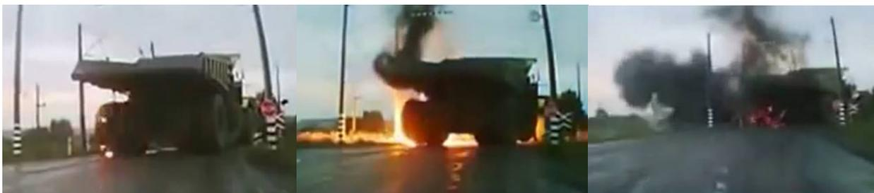
**Рис. 3.17. Пример стадии реализации ОПС – возгорание и взрыв колеса на автосамосвале во время его перевозки спец. транспортом через ж/д переезд – продолжительность стадии 15 секунд**
